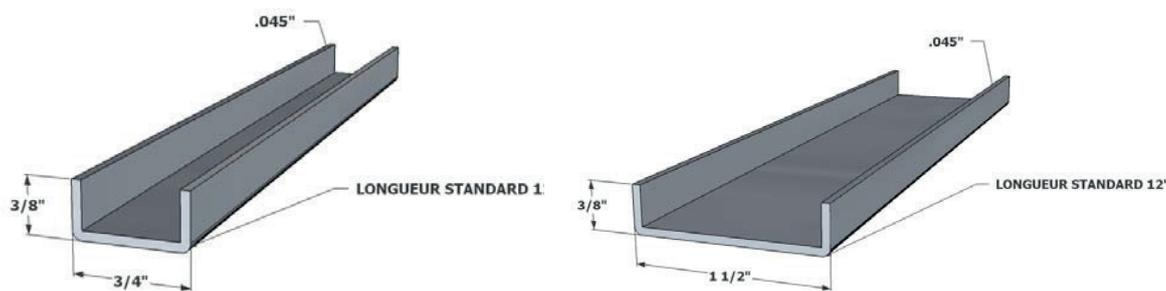
Les renforts de colombage métallique sont utilisés pour accroître la force au vent d'une cloison. Ils peuvent être utilisés pour les murs intérieurs ou extérieurs.
